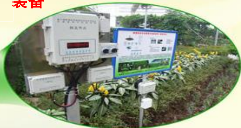
杨凌现代农业示范园中的无线汇聚节点和控制节点
