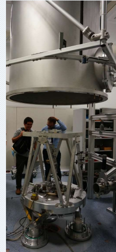
Kibble balance at LNE, France 位於法國國家計量測試實驗室的Kibble 天平
